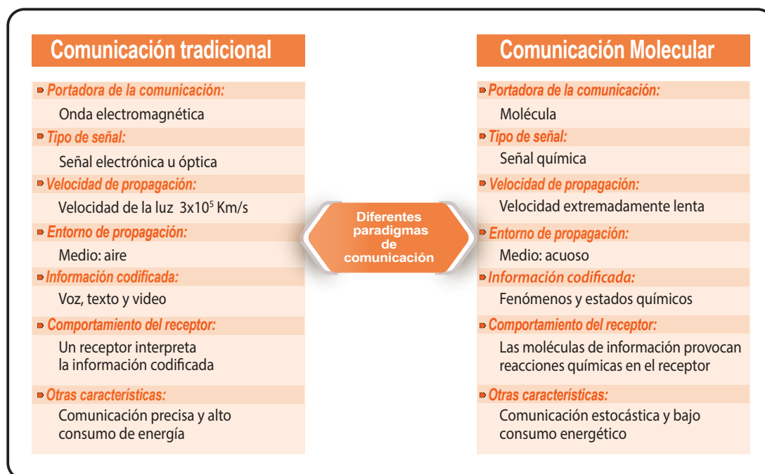
Figura 2.2. Diferencia entre los sistemas de telecomunicaciones y sistemas de CM [2].
