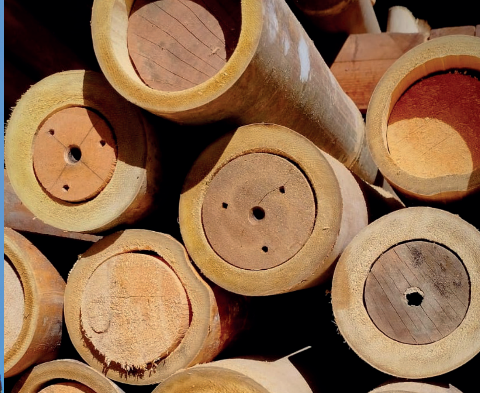
Foto No. 28. Culmos de bambú con conexiones del sistema AVECE. Culmos de bambú preparados con elementos prefabricados del sistema AVECE, listos para el ensamblaje estructural.
