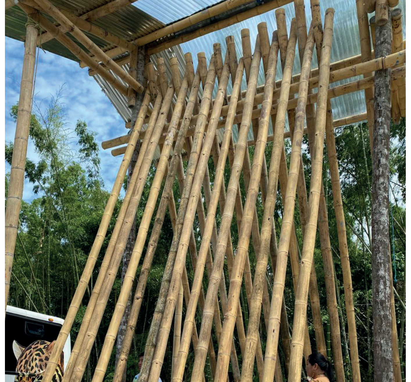
Foto No. 23 Secado del bambú. La imagen muestra el bambú aislado en una zona cubierta y protegida de la radiación solar directa.
