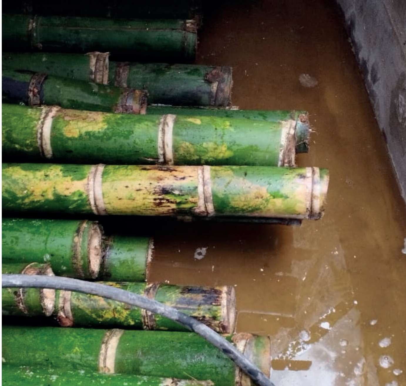
Foto No. 22. Tratamiento por inmersión en solución preservante. La imagen muestra el bambú sumergido en una piscina con una solución de bórax y ácido bórico, para prevenir el deterioro.
