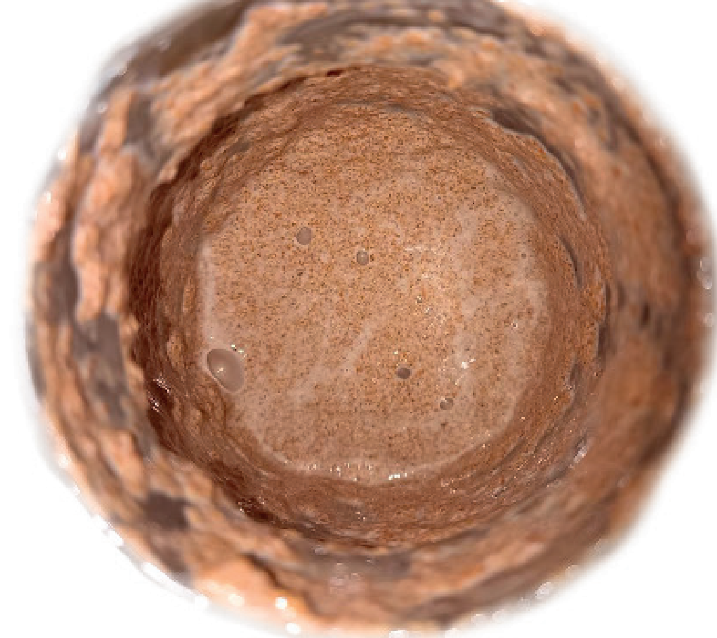
Foto No. 11 (pág. 23-24 ): Pasta de relleno para conexiones La Imagen muestra la mezcla de pasta (cola y aserrín) utilizada en el sistema AVECE.
