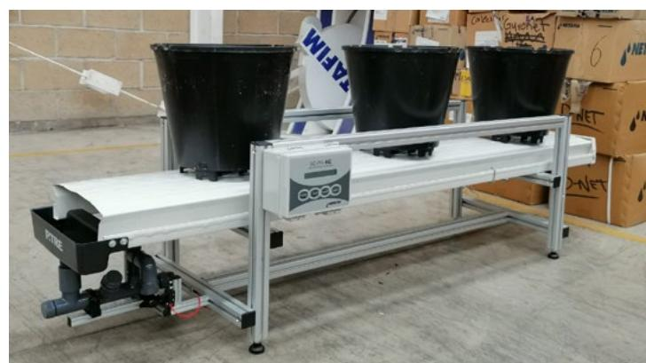
**Figura 29.** Sensores de medición de pH, CE y drenaje.
