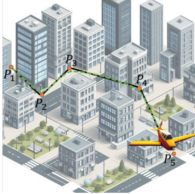
Figura 4.1: Perspectiva del problema de vuelo en 3D para un UAV de ala fija. El conjunto de puntos libres de colisión P_i se representa mediante puntos naranja; la línea negra describe la trayectoria discreta construida a partir de la planificación de trayectorias 3D; la línea verde discontinua representa la nueva trayectoria suave optimizada, seguible por el UAV.
